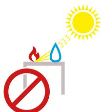
Asegúrese de que no se acumule agua sobre la placa de cristal, o entre la placa de cristal y el tablero de la mesa. La presencia de agua acumulada puede concentrar la luz solar y dañar irremediablemente las fibras de polietileno debido al efecto lupa.
